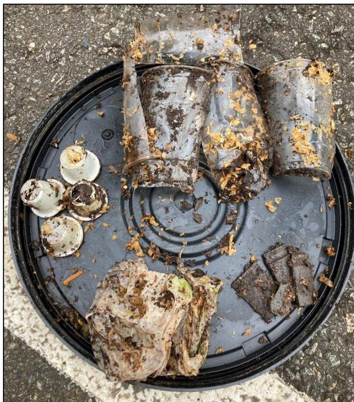
Fig. 9. Estado de degradação verificado nos produtos adicionados à composteira doméstica
